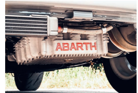
Ein zusätzlicher Ölkühler hält den kleinen Hitzkopf im Zaum.
