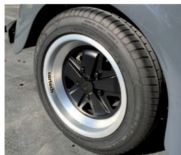
Der Käfer rollt hinten auf 225er-Reifen mit Fuchs-Felgen.
