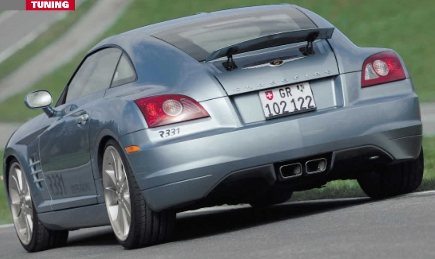
Muskulös: Der R331 unterscheidet sich nur durch die Typenbezeichnung und Räder von der Serie. Der Spoiler fährt bei 90 km/h aus.
