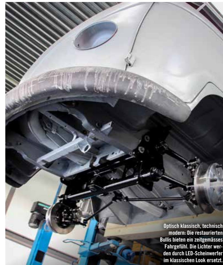
Gute Performance: Das restaurierte Käfer-Chassis hat ein modernes Sportfahrwerk und neue Bremsen. Bis 200 PS sind möglich.
