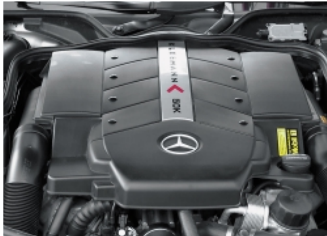
Aufgeladen: Das vom Dänen Kleemann entwickelte Kompressor-System entlockt dem 5-Liter-V8 506 PS und 675 Nm Drehmoment.
