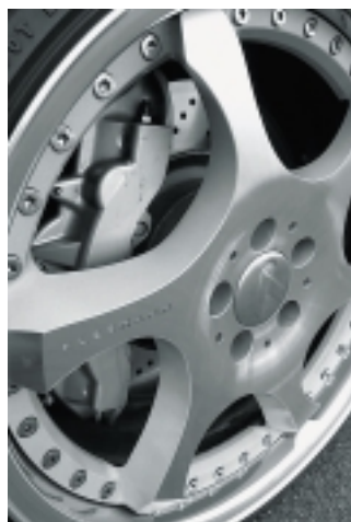
Aufgerüstet: Der CH-Importeur montiert 8-Kolben-Zangen.
